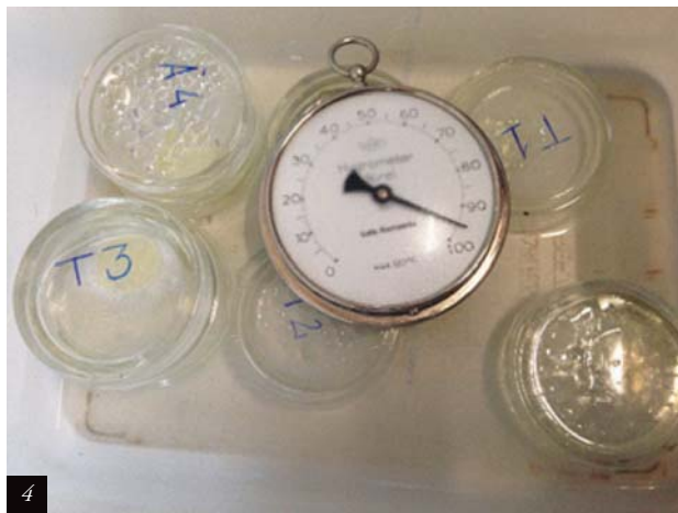
Fig. 4 y 5: Los discos fueron sumergidos en agua desionizada y acondicionados en estufa a 37°C y 99 % HR durante 24 horas.
