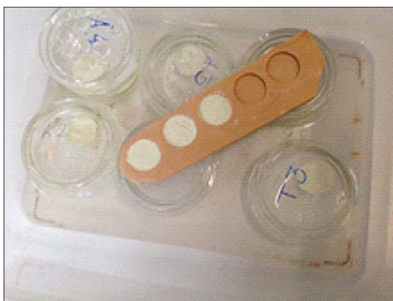
Fig. 4. Moldes de silicona de 20 mm x 1,5 mm con cemento reparador (norma UNE-EN ISO 6876:2012).
